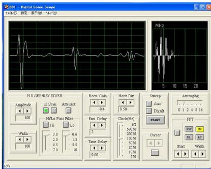
対向型SH波センサを使用し、変質を測定したい材料の基準試料の波形(伝播時間)を測定して保存します。
