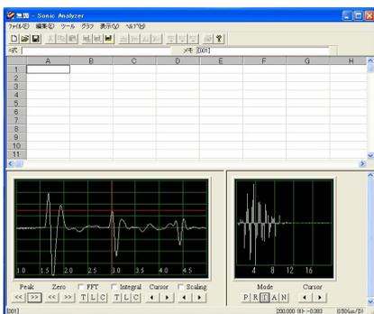
材料変質が生じた試験片の波形(伝播時間)を測定・保存し、上記基準試料との差異を、変質度合いを示すパラメータによりワークシート上で対比します。
